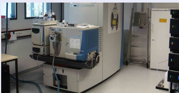
Part of the device landscape at the Leibniz-Institut für Analytische Wissenschaften in Dort-mund: Mass spectrometer and digital analyzers
